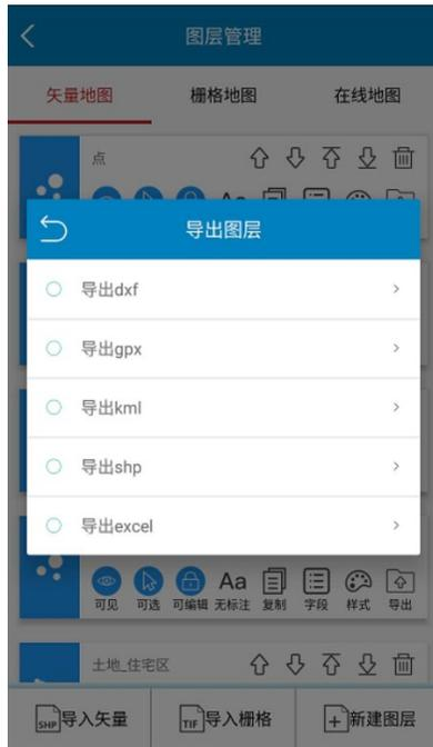
矢量图层的第二行图标按钮中，点击导出按钮，可将该图层数据导出到指定的格式文件，对于导出格式，可选择 DXF\GPX\KML\SHp 数据格式。
