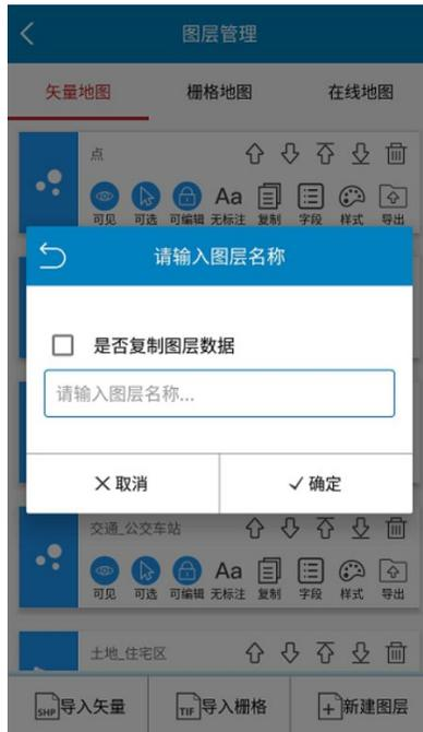
矢量图层的第二行图标按钮中，点击复制按钮，可基于选择的图层快速复制创建新的图层，在复制界面中，输入新图层名称，同时如果勾选复制图层数据，则复制新建图层时，同步复制源图层要素数据。
