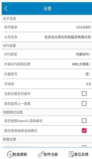
在底部菜单去点击【设置】，可进入软件设置功能，在该功能中，可查看软件版本信息，设置 GNSS 类型、CORS 差分服务、地图渲染模式、轨迹记录选项、拍照选项、单位选项等相关参数设置。
