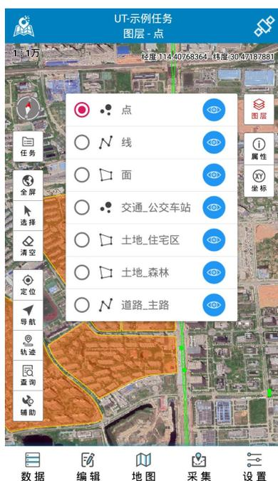
点击主地图区右侧工具条【图层】按钮，可打开图层快速设置模式，在该模式中，可快速切换选择图层（顶部标题区同步更新图层名称）、以及快速设置图层的可见或者隐藏（界面右侧图标）。
