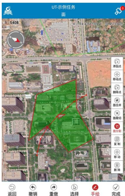
在编辑功能中，选择指定的图形要素，点击地图编辑模式按钮【面分割】，之后在图形上绘制分割线，最后点击界面底部完成按钮，结束面分割操作。
