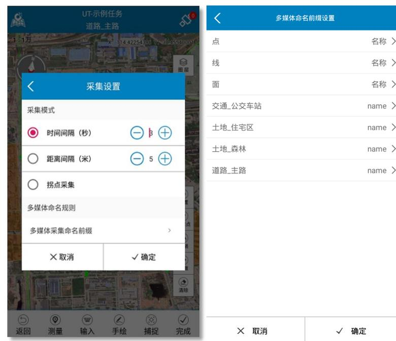
点击底部菜单区【采集】，可进入要素测量采集功能，在该功能界面，包含底部菜单按钮、和地图辅助工具按钮。点击地图辅助工具【设置】按钮，可打开采集设置界面，针对线、面图形要素，可设置时间间隔、距离间隔、拐点采集三种模式；同时对于要素的照片多媒体信息采集，可进一步设置其命名前缀规则，当选择指定的属性字段为前缀命名后，照片多媒体信息的名称将以该字段内容为开头，如“面\_1\_20190820.JPG”。
