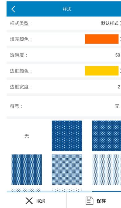
矢量图层的第二行图标按钮中，点击样式按钮，可设置图层的样式风格，包含透明度设置、边框宽度、线条颜色、填充颜色、以及符号设置，设置之后，点击界面底部【保存】按钮完成样式设置。
