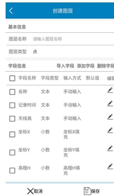
在地图功能中点击底部【新建图层】，可打开新建矢量图层界面，在该界面中，输入设置图层名称、图层类型和属性字段信息。
