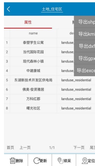
在数据管理功能中，点击右上角更多按钮，可打开数据导出界面，选择导出数据格式，软件将所有图层数据导出为指定的格式文件，导出文件位于当前任务目录下。
